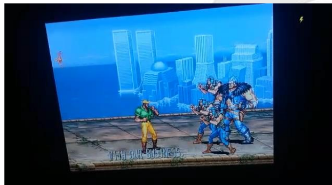
Figura 9 - Jogo Cadillacs and Dinosaurs rodando no Raspberry Pi com a marcação de “undervoltage”(raio amarelo) no canto superior direito
