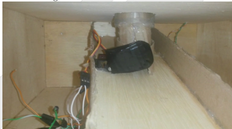
Figura 7: Servo Motor na Estrutura
