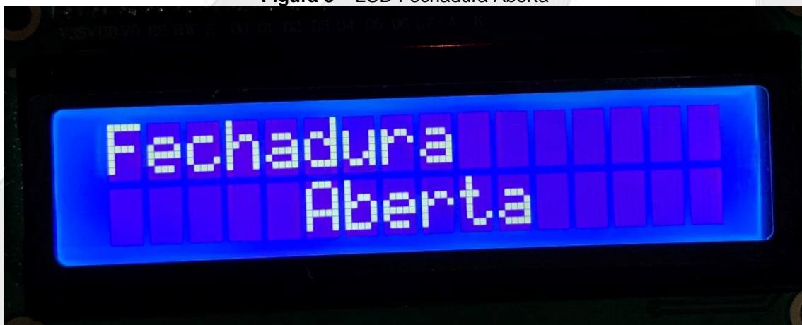
Figura 8 – LCD Fechadura Aberta
